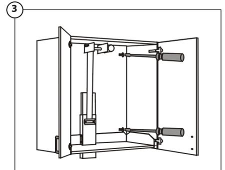
3 Fixez le fond de caisson (élément du dispositif VERTI) au mur avec au moins 6 vis.
