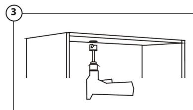
Percez le caisson dans sa partie supérieure en faisant un trou d'un diamètre d'au moins 20mm pour le passage des câbles. Le trou doit être approximativement situé à 150mm à gauche du centre du caisson et à 30mm du mur.
