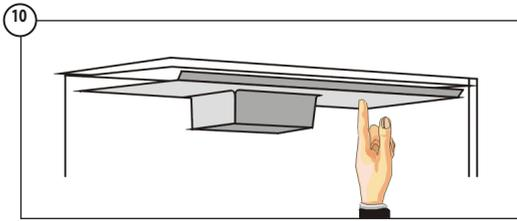
Vérifier le bon fonctionnement du dispositif de sécurité supérieur en exerçant une pression sur le cache moteur. Les étagères doivent alors opérer un mouvement vers le bas.
