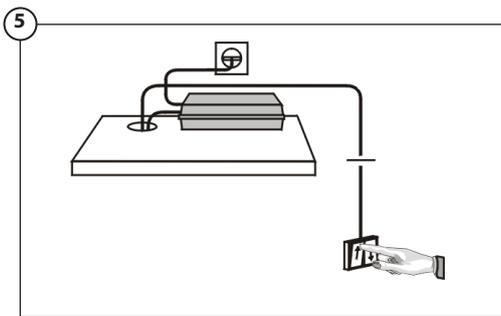
5 Installez le transformateur au dessus du caisson, à condition que celui-ci soit fixe ou sur un caisson adjacent. La prise de courant doit être facilement accessible après l'installation du dispositif.
