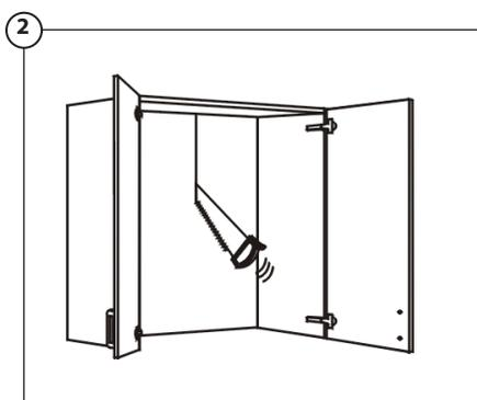
Supprimez le fond du caisson, sauf si ce dernier est fermement fixé au mur. Vérifiez également que le mur est assez solide pour supporter le poids du VERTI, en incluant la charge maximale.
