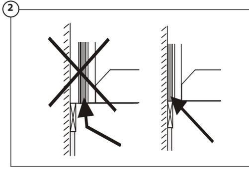
2 Le VERTI doit être fixé directement et fermement sur le mur.
