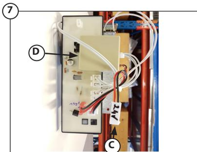
7 Raccordement des câbles sur le circuit imprimé
