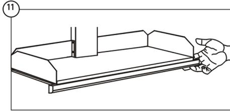
Vérifier le bon fonctionnement du dispositif de sécurité inférieur en exerçant une pression sur la plaque de sécurité fixée sous la base du VERTI (sous l'étagère basse). Les étagères doivent alors opérer un mouvement vers le haut.
