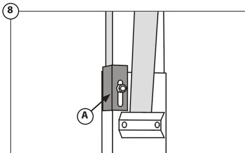
8 L'ajustement de la position haute se fait en déplaçant l'écrou (A) de bas en haut.
